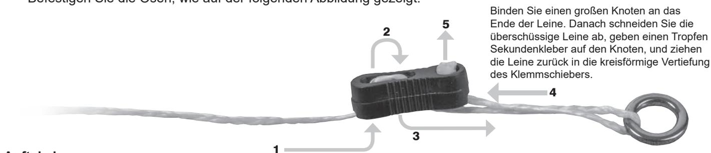
Binden Sie einen großen Knoten an das Ende der Leine. Danach schneiden Sie die überschüssige Leine ab, geben einen Tropfen Sekundenkleber auf den Knoten, und ziehen die Leine zurück in die kreisförmige Vertiefung des Klemmschiebers.
